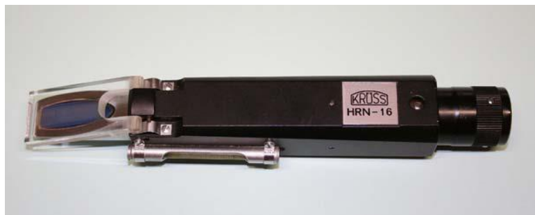
Hand-Refraktometer mit Skala für die Temperaturkompensation 1
