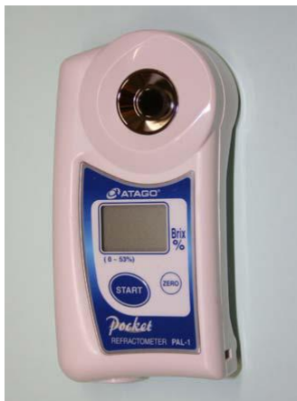
Digitales Tisch-Refraktometer mit LCD-Anzeige 1
